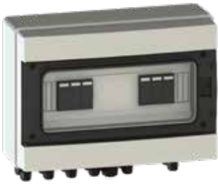
MSB-242-16-1000-TB-BC 2 MPPT / 4 input / 2 output 1000 VDC / 16A input / 32A output
